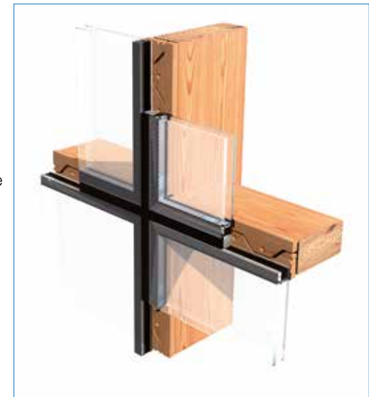
Aufbau eines HGV-Elementes Quelle: Uniglas
